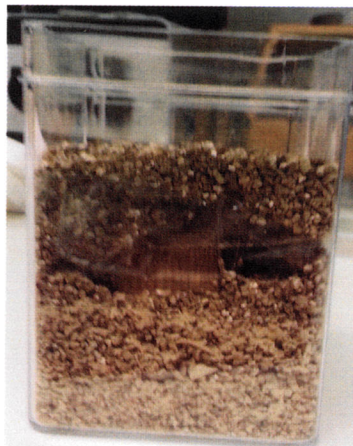
Abb. 02: Platzierung der Materialprobe (Holz in LDPE Folie) im Prüfgefäß (links) mit anschließender Eingrabung in das Substrat (rechts).
