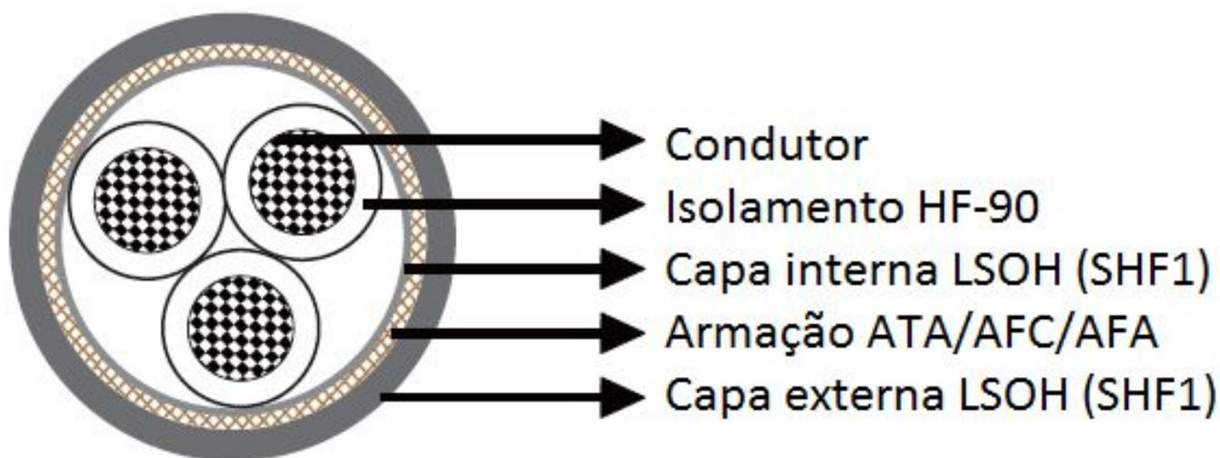
1) *Conductor formado por fios de cobre eletrolítico nu ou estanhado, têmpera mole, encordoamento classe 5. \*1,7*
