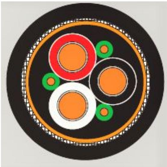
**1) Condutor formado por fios de cobre eletrolítico estanhado, têmpera mole, encordoamento classe 5, de acordo com a IEC 60228. \*1**
