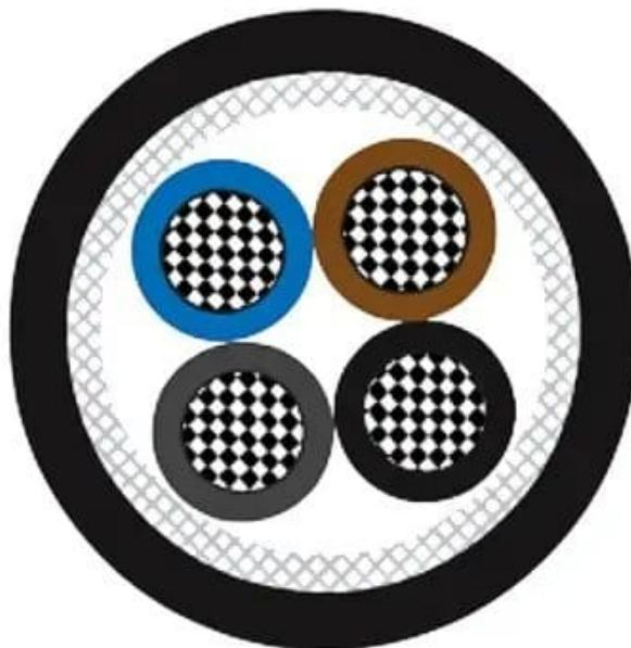
**Maritimus® Cabo Naval Multipolar de Potência e Controle; Armado; Max. 95,00mm<sup>2</sup>; 0,6/1 kV; 2 a 37 condutores; XLPE / SHF1; Flame Retardant; +90°C; IEC 60092**
