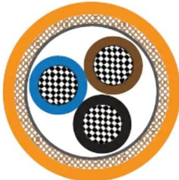
Maritimus® Cabo Naval Multipolar de Potência e Controle; Blindado; Max. 95,00mm<sup>2</sup>; 0,6/1 kV; 2 a 24 condutores; MICA / HEPR / LS0H / SHF1; Fire Resistant; +90°C; IEC 60092; 60331
