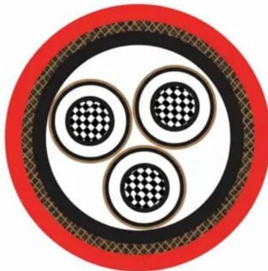
Maritimus® Cabo Naval de Potência Média Tensão; Blindado; Max. 300,00mm<sup>2</sup>; 3.6/6kV, 6/10kV, 8.7/15kV; 1 e 3 condutores; XLPE / SHF1; Flame Retardant; +90°C; IEC 60092
