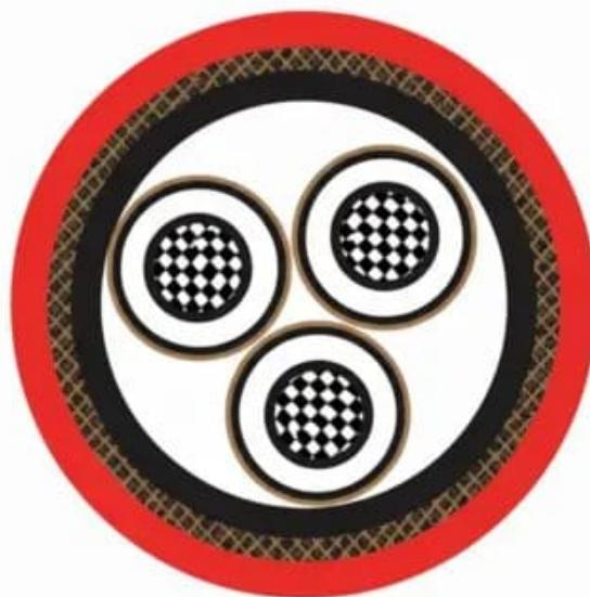
Maritimus® Cabo Naval de Potência Média Tensão; Blindado e Armado; Max. 300,00mm<sup>2</sup>; 3.6/6kV, 6/10kV, 8.7/15kV; 1 e 3 condutores; XLPE / SHF1; Flame Retardant; +90°C; IEC 60092
