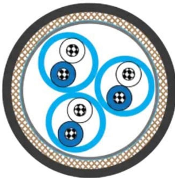
**Maritimus® Cabo Naval Instrumentação e Controle; Multipares / Multiternas; PiMF / TiMF; Blindagem Individual; Armado; Max. 1,50mm<sup>2</sup>; 150/250V; 1 a 37 pares / ternas; XLPE / SHF1; Flame Retardant; +90°C; IEC 60092**
