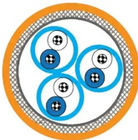
**Maritimus® Cabo Naval Instrumentação e Controle; Multipares / Multiternas (PiMF/TiMF); Blindagem Individual e Coletiva; Max. 1,50mm<sup>2</sup>; 150/250V; 1 a 37 pares / ternas; MICA / XLPE / SHF1; Fire Resistant; +90°C; IEC 60092, 60331**
