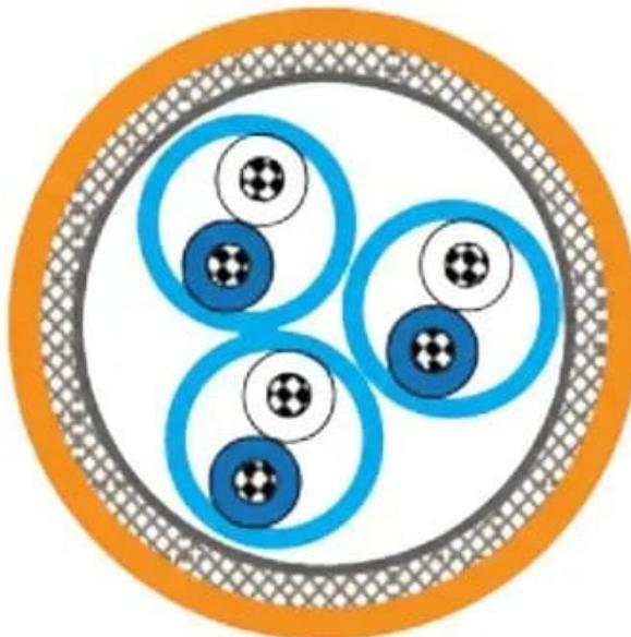
**Maritimus® Cabo Naval Instrumentação e Controle; Multipares / Multiternas (PiMF/TiMF); Blindagem Individual; Armado; Max. 1,50mm<sup>2</sup>; 150/250V; 1 a 37 pares / ternas; MICA / XLPE / SHF1; Fire Resistant; +90°C; IEC 60092, 60331**
