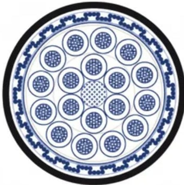
Cabo de Potência e Controle; Armado; 300/500V ; 3 a 100 condutores; max. 95,00mm<sup>2</sup>;
