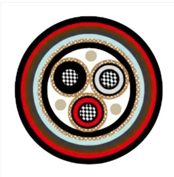
HydroCore® Cabo Naval NEK 606 Water Blocked P6 or P6/P13 BFOU; 3.6/6KV; Potência Média Tensão; Armado; Max. 300,00mm<sup>2</sup>; 1 a 3 condutores; MICA + XLPE – EPR / SHF2 – SHF MUD / PUR; Fire resistant; +90°C
