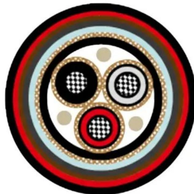
HydroCore® Cabo Naval NEK 606 Water Blocked P4 or P4/P11 RF0U/TF0U; 8.7/15KV; Potência Média Tensão; Armado; Max. 300,00mm<sup>2</sup>; 1 a 3 condutores; XLPE – EPR / SHF2 – SHF MUD / PUR; Flame retardant; +90°C
