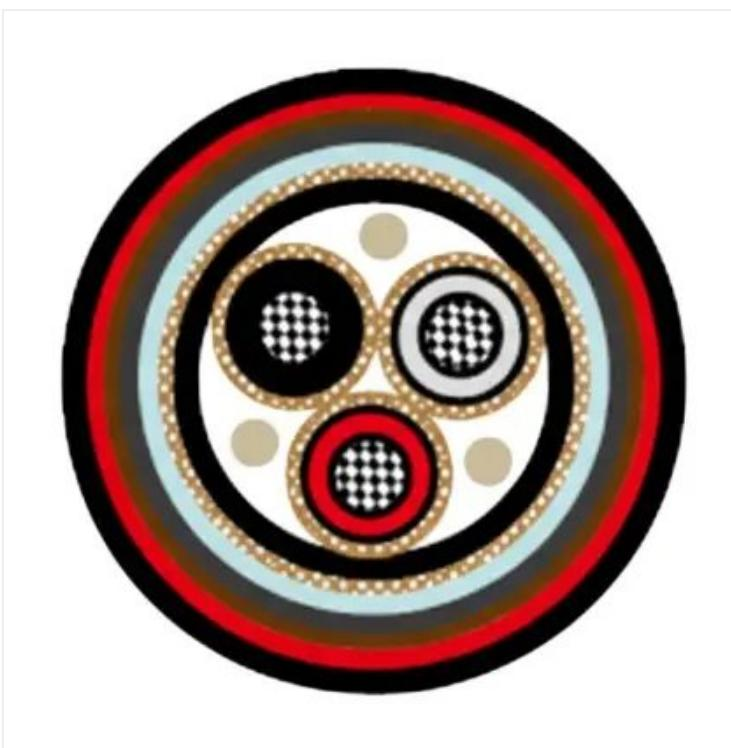
HydroCore® Cabo Naval NEK 606 Water Blocked P3 ou P3/P10 RF0U/TF0U; 6/10KV; Potência Média Tensão; Armado; Max. 300,00mm<sup>2</sup>; 1 a 3 condutores; XLPE – EPR / SHF2 – SHF MUD / PUR; Flame retardant; +90°C
