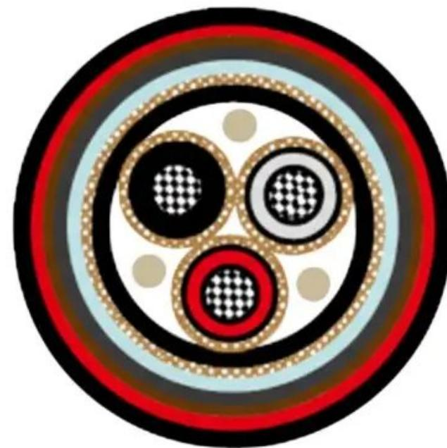
HydroCore® Cabo Naval NEK 606 Water Blocked P2 ou P2/P9 RF0U/TF0U; 3.6/6KV; Potência Média Tensão; Armado; Max. 300,00mm<sup>2</sup>; 1 a 3 condutores; XLPE – EPR / SHF2 – SHF MUD / PUR; Flame retardant; +90°C
