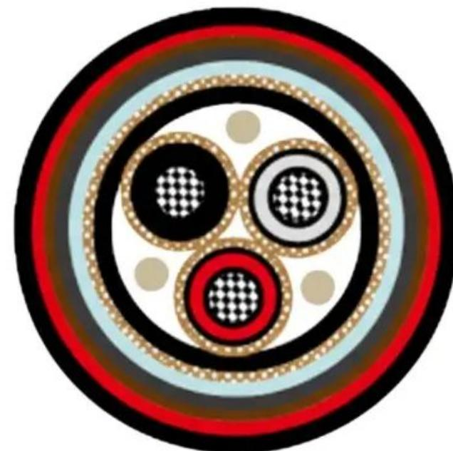
HydroCore® Cabo Naval NEK 606 Water Blocked P19 or P19/P21 RF0U/TF0U; 12/20KV; Potência Média Tensão; Armado; Max. 300,00mm<sup>2</sup>; 1 a 3 condutores; XLPE – EPR / SHF2 – SHF MUD / PUR; Flame retardant; +90°C
