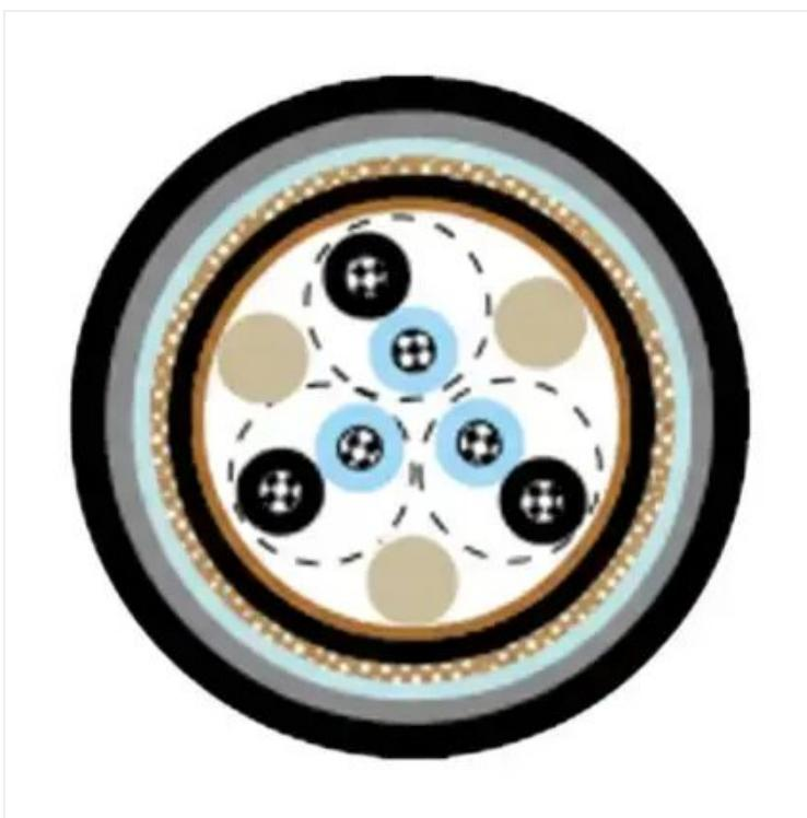
HydroCore® Cabo Naval NEK 606 Water Blocked S4 or S4/S8 BF0U(c); 250V; Instrumentação e Controle; Blindagem Coletiva; Armado; Max. 2,50mm<sup>2</sup>; 1 a 37 pares / ternas ; MICA + HFEPR / SHF2 – SHF MUD / PUR; Fire resistant; +90°C
