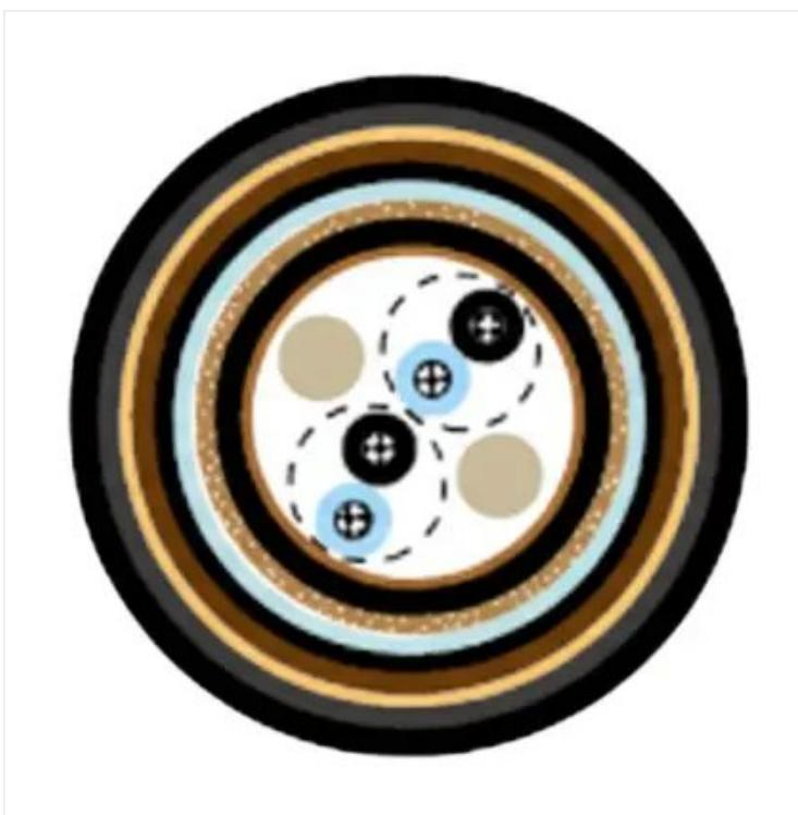
HydroCore® Cabo Naval NEK 606 Water Blocked S16 BF0U-HCF(c); 250V; Instrumentação e Controle; Blindagem Coletiva; Armado; Max. 1,50mm<sup>2</sup>; 2 a 12 pares; MICA + HFEPR / SHF2 / HC FIRE / SHF1 / PUR; Fire resistant; +90°C
