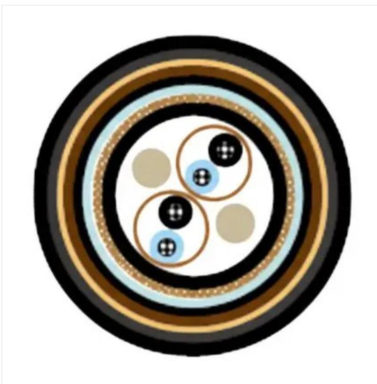
HydroCore® Cabo Naval NEK 606 Water Blocked S15 BFOU-HCF(i); 250V; Instrumentação e Controle; Blindagem Individual; Armado; Max. 1,50mm<sup>2</sup>; 1 a 12 pares; MICA + HFEPR / SHF2 / HC FIRE / SHF1 / PUR; Fire resistant; +90°C
