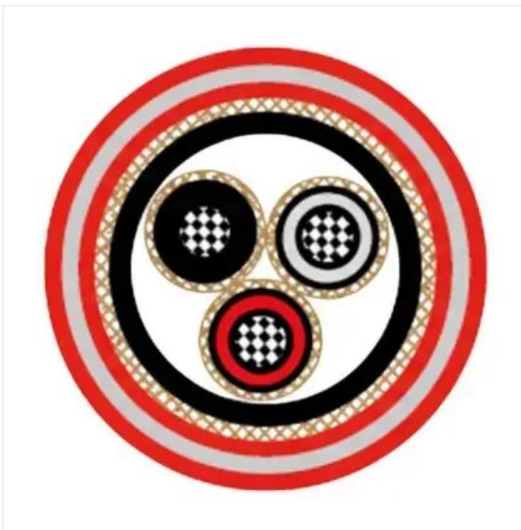
DeepSea® Cabo Naval NEK 606 P115 RFOU-HCF / TFOU-HCF; 8.7/15 (17.5) kV; Potência Média Tensão; Armado; Max. 300,00mm<sup>2</sup>; 1 a 03 condutores; MICA + XLPE – EPR / LSOH / SHF2 / LSOH HC / SHF1; Fire Resistant; +90°C
