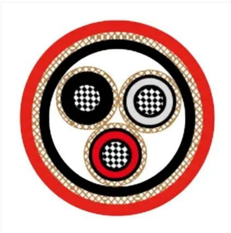
DeepSea® Cabo Naval NEK 606 P113 RF0U/TF0U; 18/30 (36)kV; Potência Média Tensão; Armado; Max. 300,00mm<sup>2</sup>; 1 a 03 condutores; XLPE – EPR / LS0H / SHF2 – SHF2 MUD; Flame Retardant; +90°C
