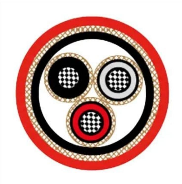
DeepSea® Cabo Naval NEK 606 P104 (P4 ou P4/P11) RFOU/TFOU; 8.7/15KV; Potência Média Tensão; Armado; Max. 300,00mm<sup>2</sup>; 1 a 03 condutores; XLPE – EPR / LS0H / SHF2 – SHF2 MUD; Flame Retardant; +90°C
