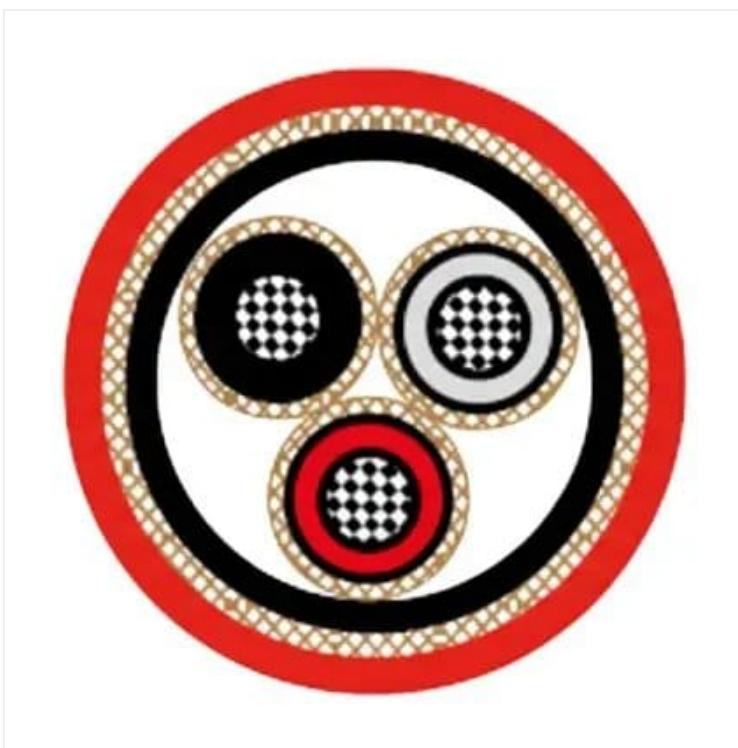
DeepSea® Cabo Naval NEK 606 P103 (P3 or P3/P10) RF0U/TF0U; 6/10KV; Potência Média Tensão; Armado; Max. 300,00mm<sup>2</sup>; 1 a 03 condutores; XLPE – EPR / LSOH / SHF2 – SHF2 MUD; Flame Retardant; +90°C
