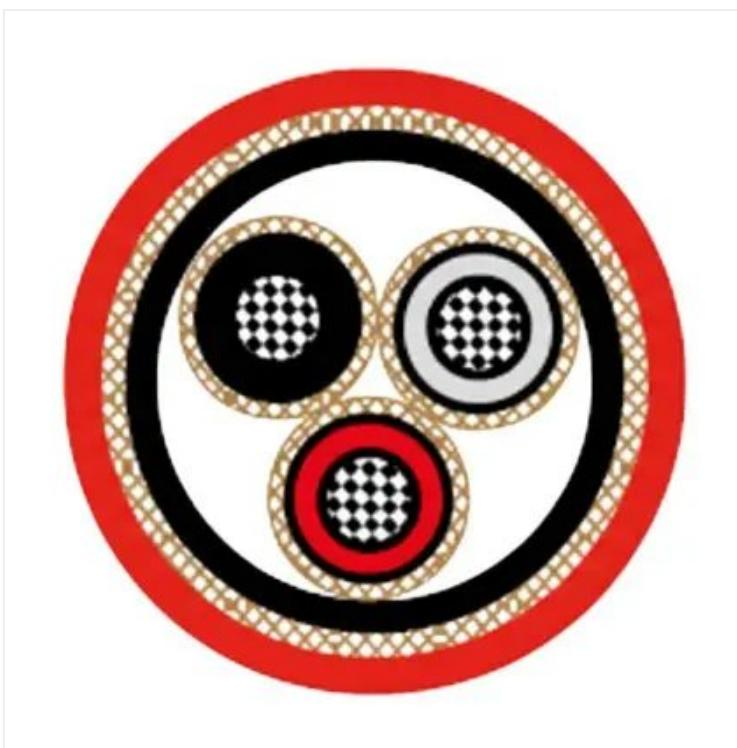
DeepSea® Cabo Naval NEK 606 P102 (P2 or P2/P9) RF0U/TFOU; 3.6/6KV; Potência Média Tensão; Armado; Max. 300,00mm<sup>2</sup>; 1 a 03 condutores; XLPE – EPR / LSOH / SHF2 – SHF2 MUD; Flame Retardant; +90°C
