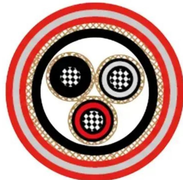
DeepSea® Cabo Naval NEK 606 P121 RF0U / TF0U; 6/10 (12) kV; Potência Média Tensão; Armado; Max. 300,00mm<sup>2</sup>; 1 a 03 condutores; MICA + XLPE – EPR / LSOH / SHF2 / LSOH HC / SHF1; Fire Resistant; +90°C
