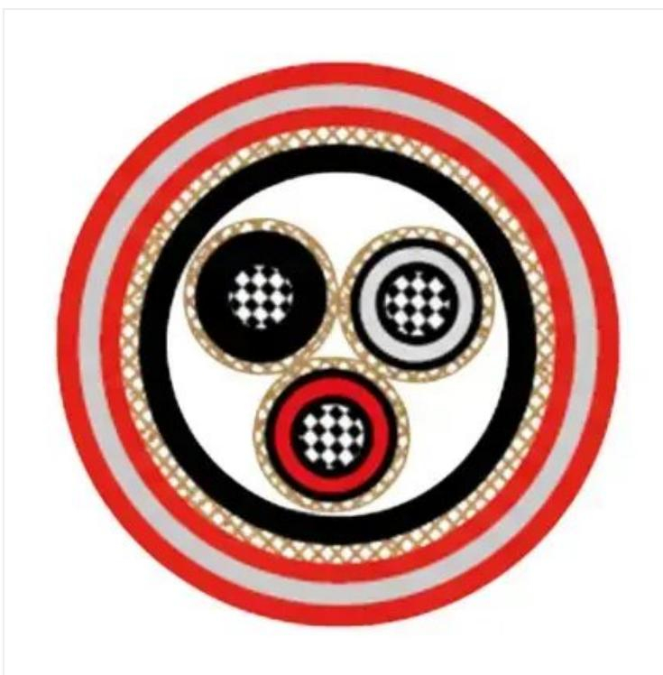
DeepSea® Cabo Naval NEK 606 P116 RFOU-HCF / TFOU-HCF; 12/20 (24) kV; Potência Média Tensão; Armado; Max. 300,00mm<sup>2</sup>; 1 a 03 condutores; MICA + XLPE – EPR / LSOH / SHF2 / LSOH HC / SHF1; Fire Resistant; +90°C
