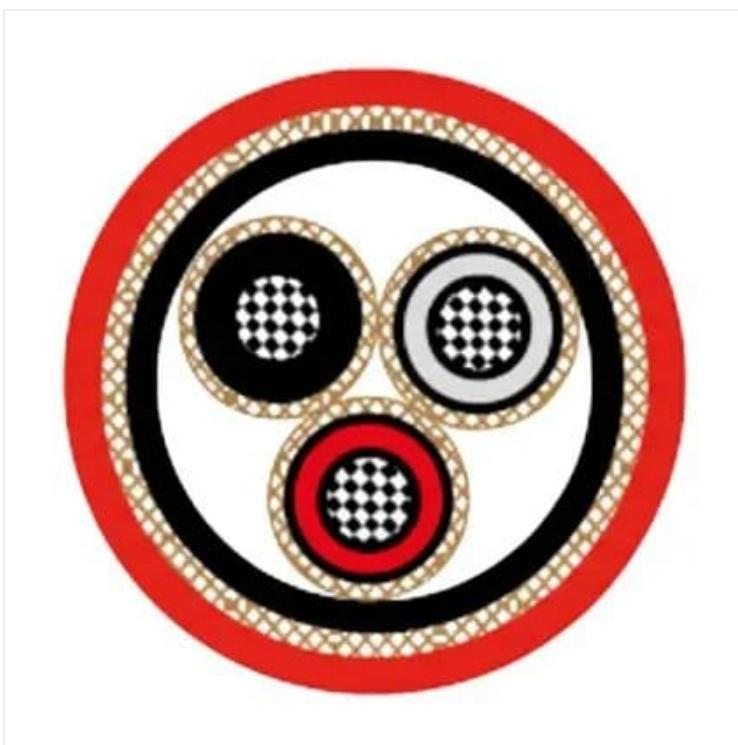
DeepSea® Cabo Naval NEK 606 P107 (P7 ou P7/P14) BF0U/TF0U; 6/10kV; Potência Média Tensão; Armado; Max. 300,00mm<sup>2</sup>; 1 a 03 condutores; MICA + XLPE – EPR / LSOH / SHF2 – SHF2 MUD; Fire Resistant; +90°C
