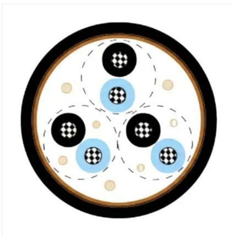
DeepSea® Cabo Naval de Instrumentação e Controle; NEK 606; S108 (S14) BU(c); 250V;
