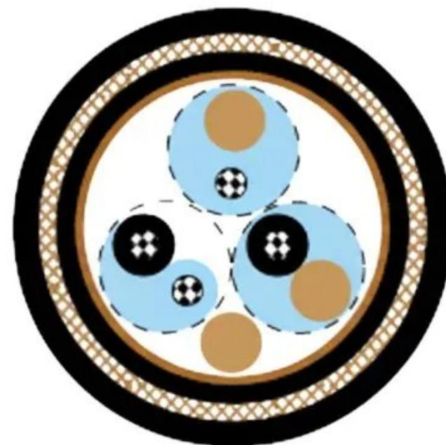
DeepSea® Cabo Naval de Instrumentação e Controle; NEK 606; S104 (S4 or S4/S8)
