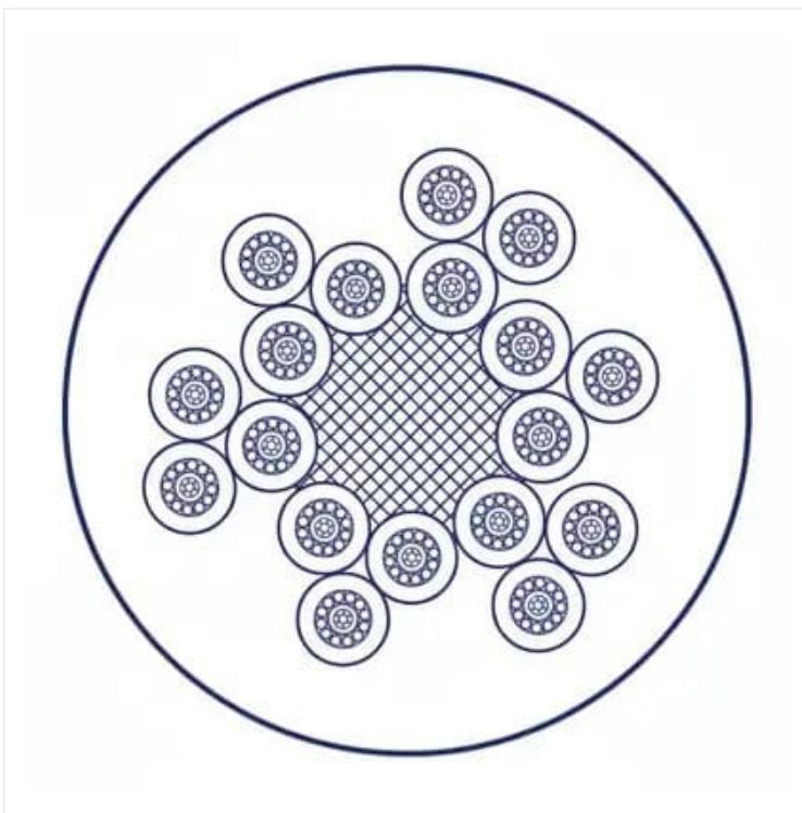
Cabo de Potência e Controle; Blindado, Uso Móvel; 300/500 V; 2 a 42 condutores; Veias Numeradas; LSZH, Innovlon/CECO™, Resistência a Óleos; -40°C/+100°C
