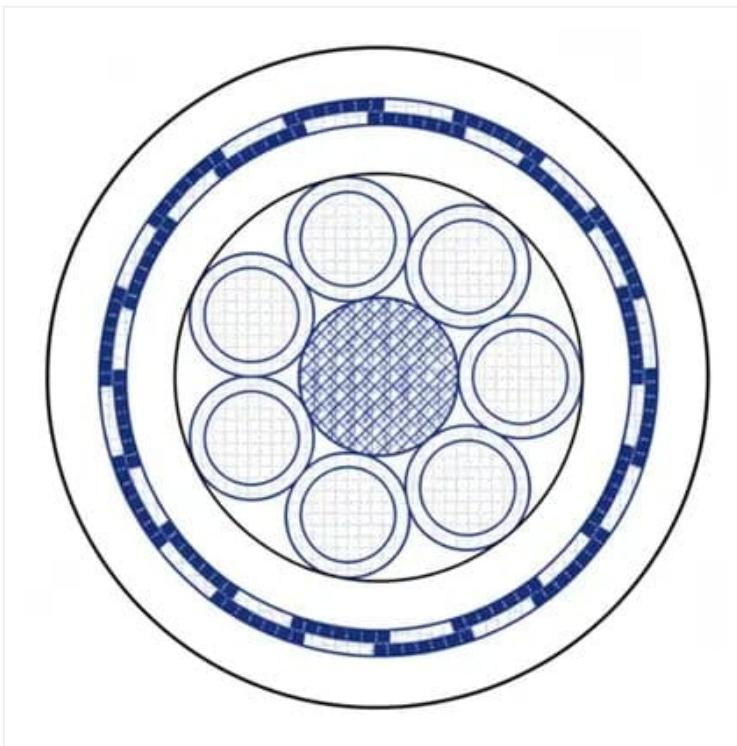
Cabo de Potência e Controle, Uso Móvel; 750V; 2 A 4 condutores; max. 95,00mm<sup>2</sup>,
