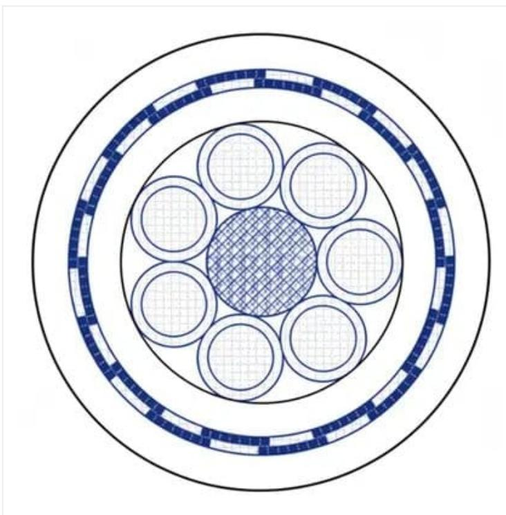
Cabo de Potência e Controle, Uso Móvel; 750V; 2 e 3 condutores; max. 95,00mm<sup>2</sup>,
