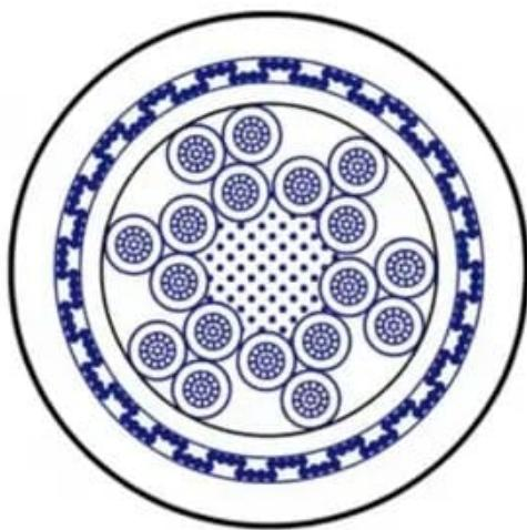
Cabo de Potência e Controle, Uso Móvel; 750 V; 2 a 25 condutores; max. 4,00mm<sup>2</sup>,
