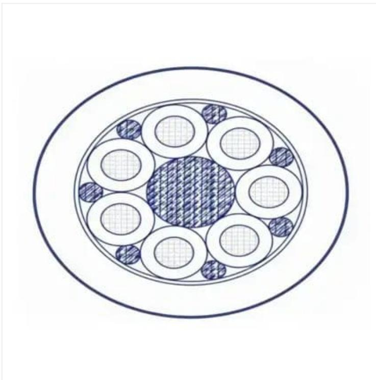
Cabo de Potência e Controle; Uso Móvel; até 0,75mm<sup>2</sup> 300/500V; Acima de 1,00mm<sup>2</sup> 500/750V; 2 a 42 condutores; Veias Numeradas; PVC/PUR, Resistência a Óleos; -30°C/+80°C
