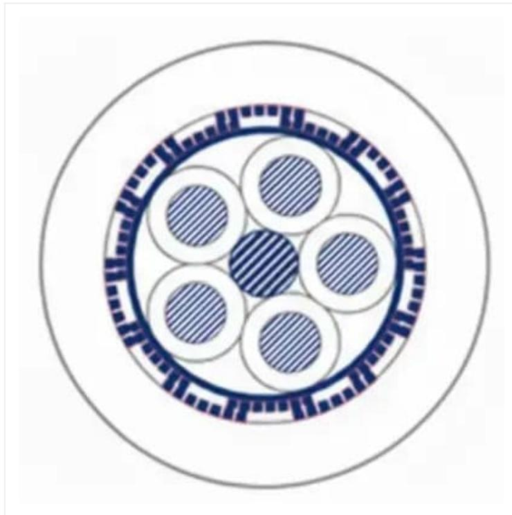
Cabo de Potência e Controle; Uso Móvel; até 0,75mm<sup>2</sup> 300/500V; Acima de 1,00mm<sup>2</sup> 500/750V; 2 a 42 condutores; Veias Numeradas; PVC/PUR, Resistência a Chama e Óleos; -40°C/+80°C
