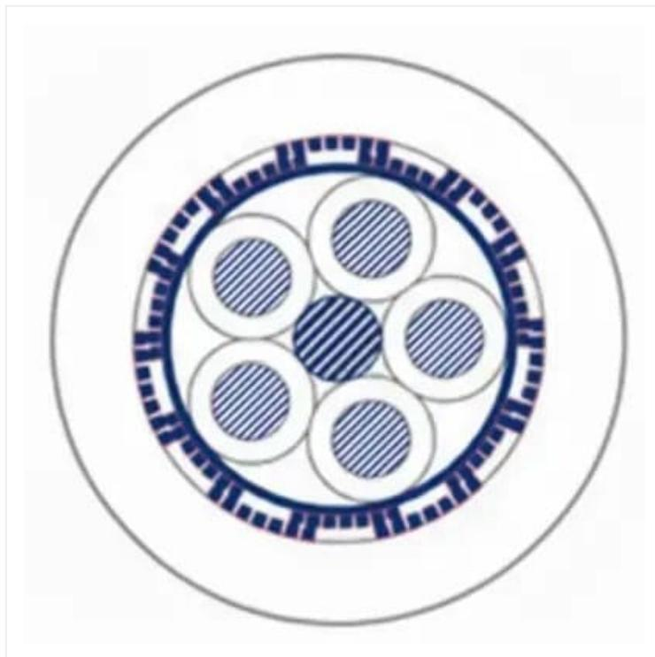
Cabo de Potência e Controle; Blindado, Uso Móvel; até 0,75mm<sup>2</sup> 300/500V; Acima de 1,00mm<sup>2</sup> 500/750V; 2 a 42 condutores; Veias Numeradas; PVC/PVC/PUR, Resistência a Óleos; -30°C/+80°C
