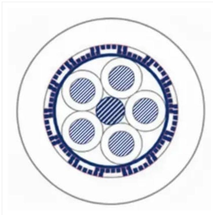
Cabo de Potência e Controle; Blindado, Uso Móvel; até 0,75mm<sup>2</sup> 300/500V; Acima de 1,00mm<sup>2</sup> 500/750V; 2 a 42 condutores; Veias Numeradas; PVC/PVC/PUR, Resistência a Chama e Óleos; -30°C/+80°C
