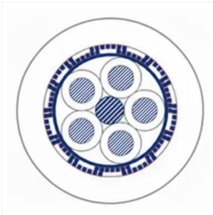
Cabo de Potência e Controle; Blindado, Uso Móvel; até 0,75mm<sup>2</sup> 300/500V; Acima de 1,00mm<sup>2</sup> 500/750V; 2 a 42 condutores; Veias Numeradas; PVC/PVC/PVC, Resistência a Chama e a Óleos; -30°C/+80°C
