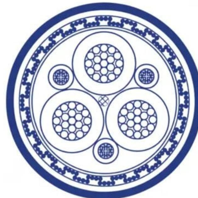
Cabo de Potência para inversor de frequencia; 0,6/1 kV; 3 + 3 condutores; Max. 95/16 mm<sup>2</sup>; XLPE / PVC; 90°C
