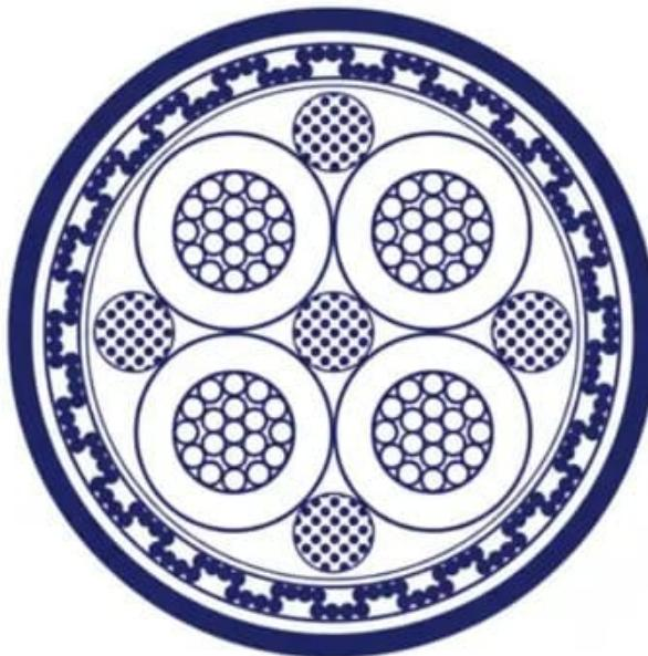
Cabo de Potência para inversor de frequencia; 0,6/1 kV; 4 condutores; Max. 95,00 mm<sup>2</sup>; XLPE / PVC; 90°C
