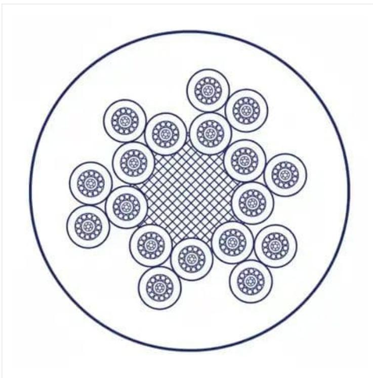
Cabo de Potência e Controle; Blindado, Uso Móvel; 300/500 V; 2 a 42 condutores; Veias Numeradas; LSZH, Innovlon/CEAC™, Resistência a Chama e Óleos; -40°C/+100°C
