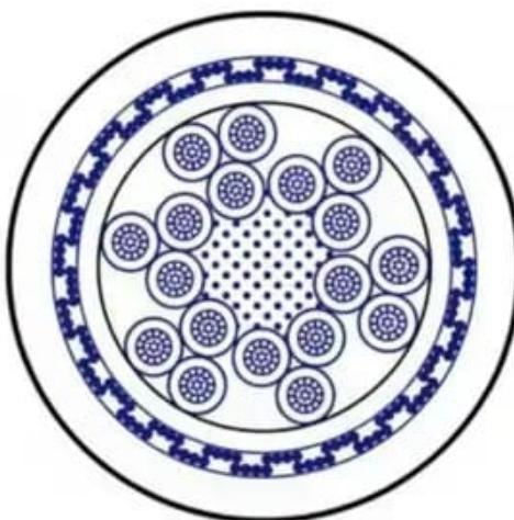
Cabo de Potência e Controle; Blindado, Uso Móvel; 600 V; 2 a 42 condutores; Veias Numeradas, PVC/PVC/PVC, Resistência a Chama e Óleos; -40°C/+80°C
