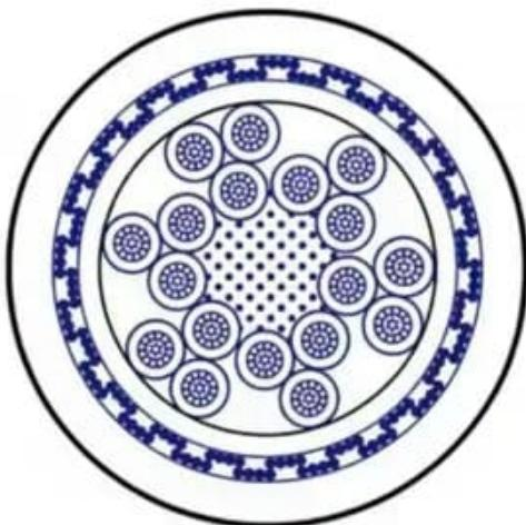
Cabo de Potência e Controle; Blindado, Uso Móvel; 1000V; 2 a 42 condutores; Veias Numeradas; LSZH, Innovlon/PUR/PUR, Resistência a Óleos; -40°C/+100°C
