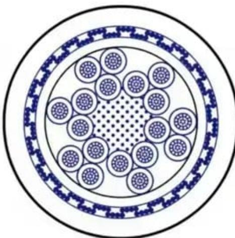
Cabo de Potência e Controle; Blindado, Uso Móvel; 300/500 V; 2 a 42 condutores; Veias Numeradas; LSZH, Innovlon/CECO™/CEAC™, Resistência a Chama e Óleos; -40°C/+100°C
