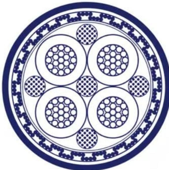
Cabo de Potência para inversor de frequencia; 0,6/1 kV; 4 + 2 + 2 condutores;
