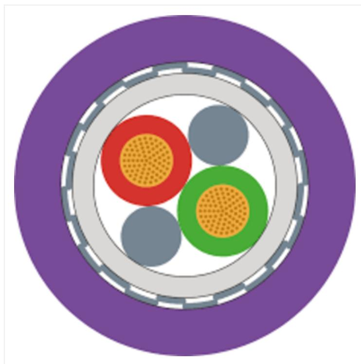
Cabo de barramento; PROFIBUS DP; Instalação fixa; Impedância característica nominal: 150 Ω; PVC; violeta
