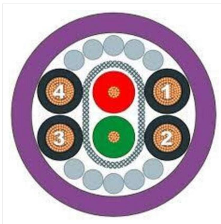
Cabo de barramento; PROFIBUS DP; Uso móvel; Esteiras porta-cabos; Impedância característica nominal: 150 Ω; PUR; 1X2X0,64+4X1,5; violeta
