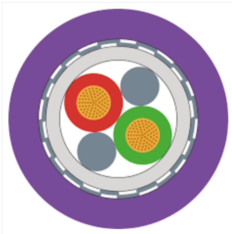
Cabo de barramento; PROFIBUS DP; Instalação fixa; Impedância característica nominal: 150 Ω; TPE; violeta, 105°C
