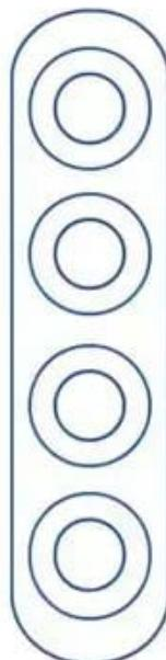
Cabo Chato de Potência e Controle, Uso Móvel; 300/500V; até 12 condutores, até 300,00mm<sup>2</sup>; Veias Numeradas; LSZH; CECO™ /CEAC™ , Resistência a chama e respingos de óleos; -40°C/+130°C
