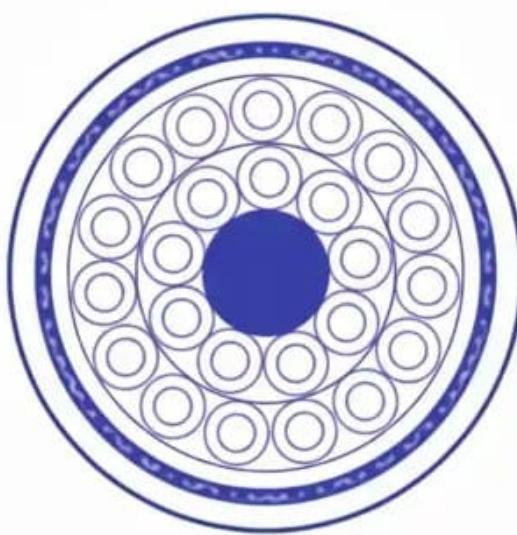
Cabo de Potência e Controle, Uso Móvel; 0,6/1 kV; 4 a 44 condutores; max. 70,0mm<sup>2</sup>, Veias Numeradas; LSZH, CECO™ / CECO™ / CEAC™, Resistência a chama e Óleos; -50°C/+80°C
